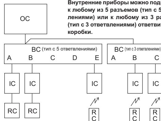
\* Для получения подробной информации по подключению проводов для внутренних приборов P100 обратитесь к руководству по установке ответвительной коробки (PAC-AK52BC).
