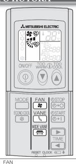
Нажмите , чтобы выбрать скорость вентилятора. При каждом нажатии скорость вентилятора изменяется в следующем порядке:
