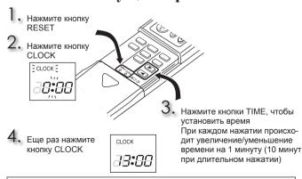
Осторожно нажмите кнопку RESET и CLOCK с помощью тонкой палочки. Если не нажать кнопку RESET, кондиционер может работать неправильно.
